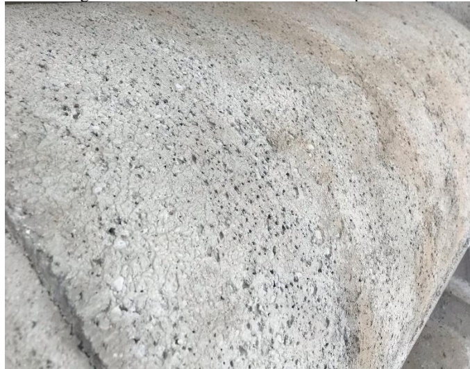
Figura 10 – Bolhas em manilhas na empresa B.
