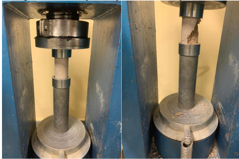
Figura 26 - Antes e depois da ruptura com 7 dias: traço T2.
