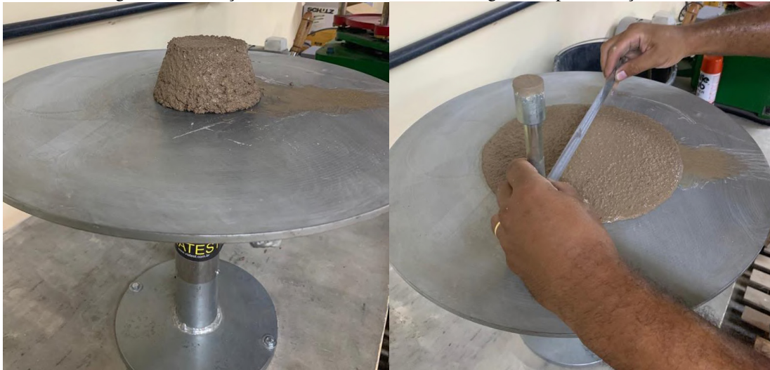
Figura 24 - Medição do índice de consistência da argamassa para o traço T2.
