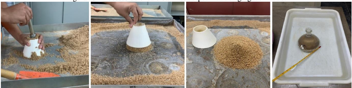
Figura 15- Processo do ensaio da massa específica do agregado miúdo.
