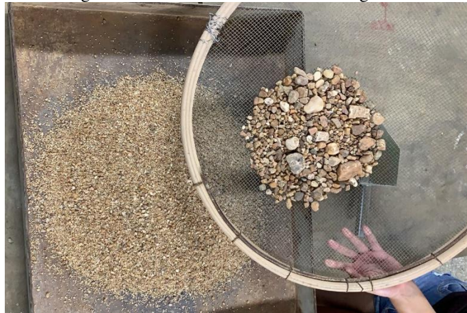
Figura 14 - Retirada dos seixos da areia grossa.
