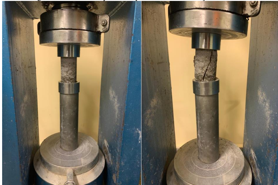
Figura 25 - Antes e depois da ruptura com 7 dias: traço T1.
