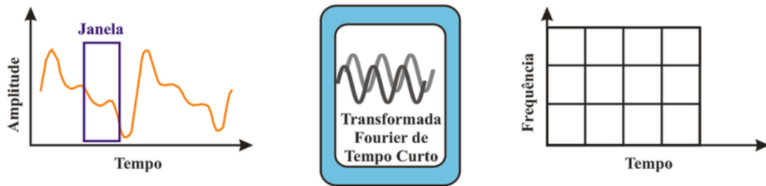
Figura 12 - Análise bidimensional de um sinal utilizando a STFT
