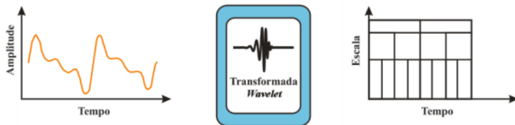
Figura 13 - Análise de um sinal utilizando a transformada wavelet
