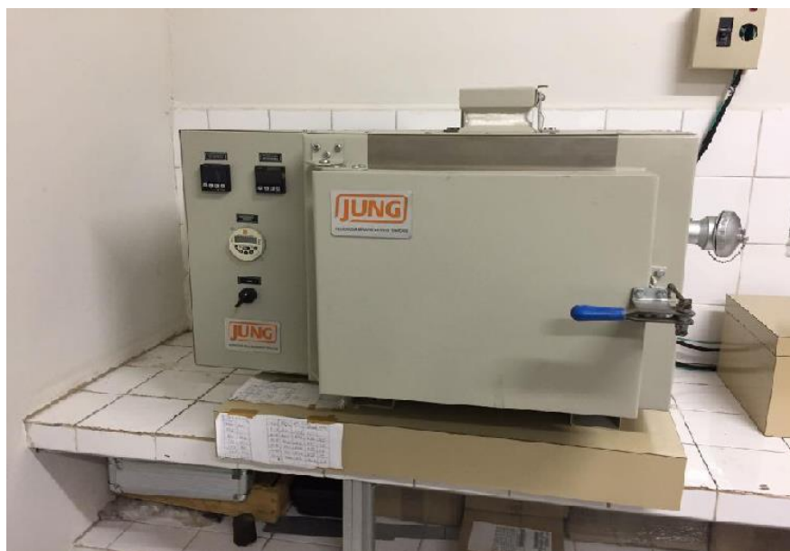
Figura 20 – Forno usado para o aquecimento das amostras
