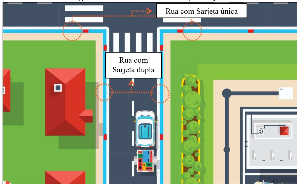
Figura 28 – Vazões de escoamento para sarjetas.
