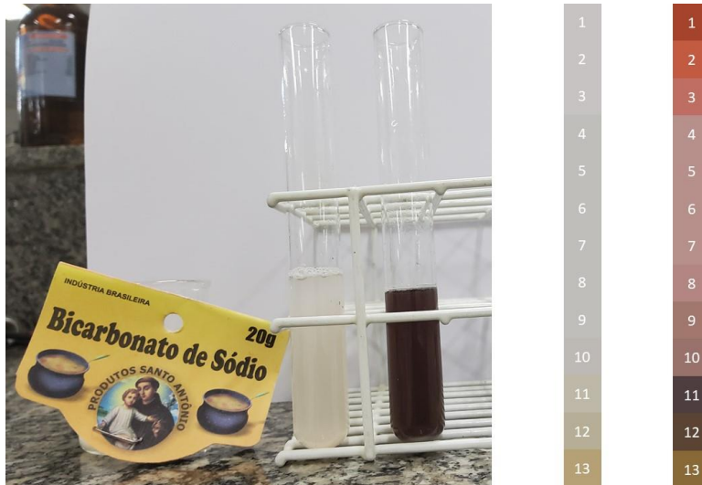
Figura 12 – Identificação do pH do bicarbonato de sódio utilizando os extratos de arroz preto e arroz vermelho.
