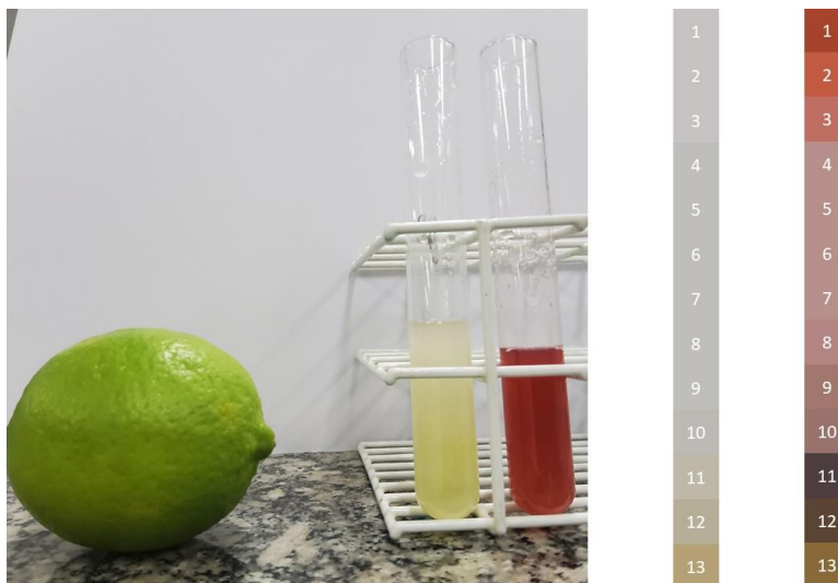
Figura 9 - Identificação do pH do sumo do limão utilizando os extratos de arroz preto e arroz vermelho.
