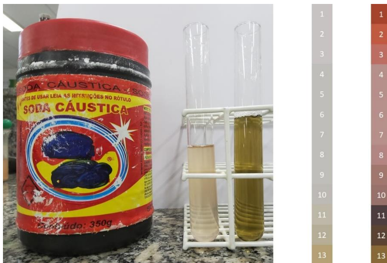
Figura 15 - Identificação do pH da soda cáustica utilizando os extratos de arroz preto e arroz vermelho.
