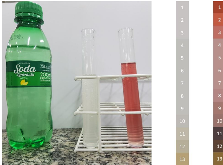
Figura 10 – Identificação do pH da refrigerante sprite utilizando os extratos de arroz preto e arroz vermelho.
