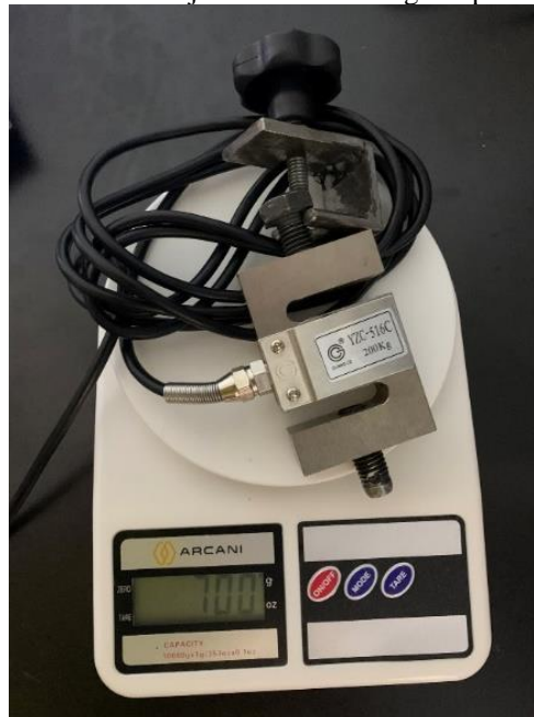
Figura 35 - Peso do conjunto célula de carga e apoio deslizante.
