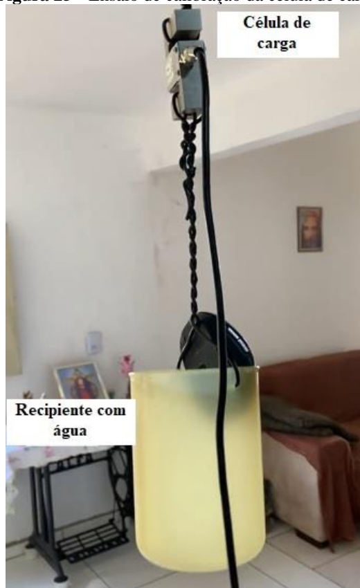
Figura 25 - Ensaio de calibração da célula de carga.
