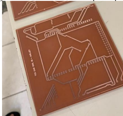
Figura 28 - Placa de circuito impresso pronta.
