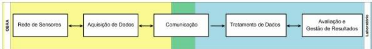
Figura 5 - Sistema de aquisição e monitoramento de dados.
