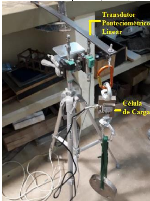
Figura 18 - Sistema desenvolvido para medição de força e deslocamento.
