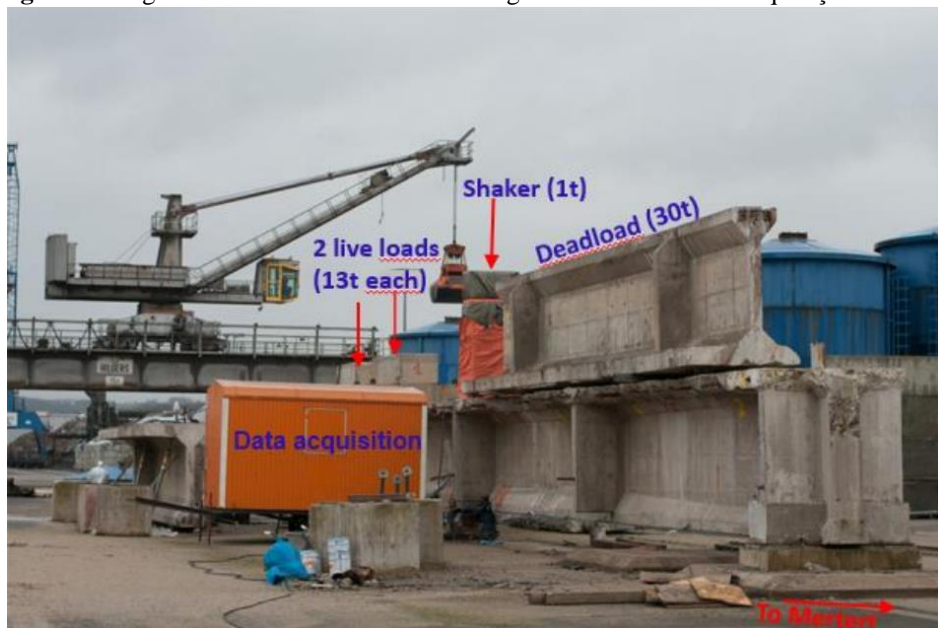
Figura 2 - Viga Retirada da Ponte com os carregamentos e sistema de aquisição de dados.
