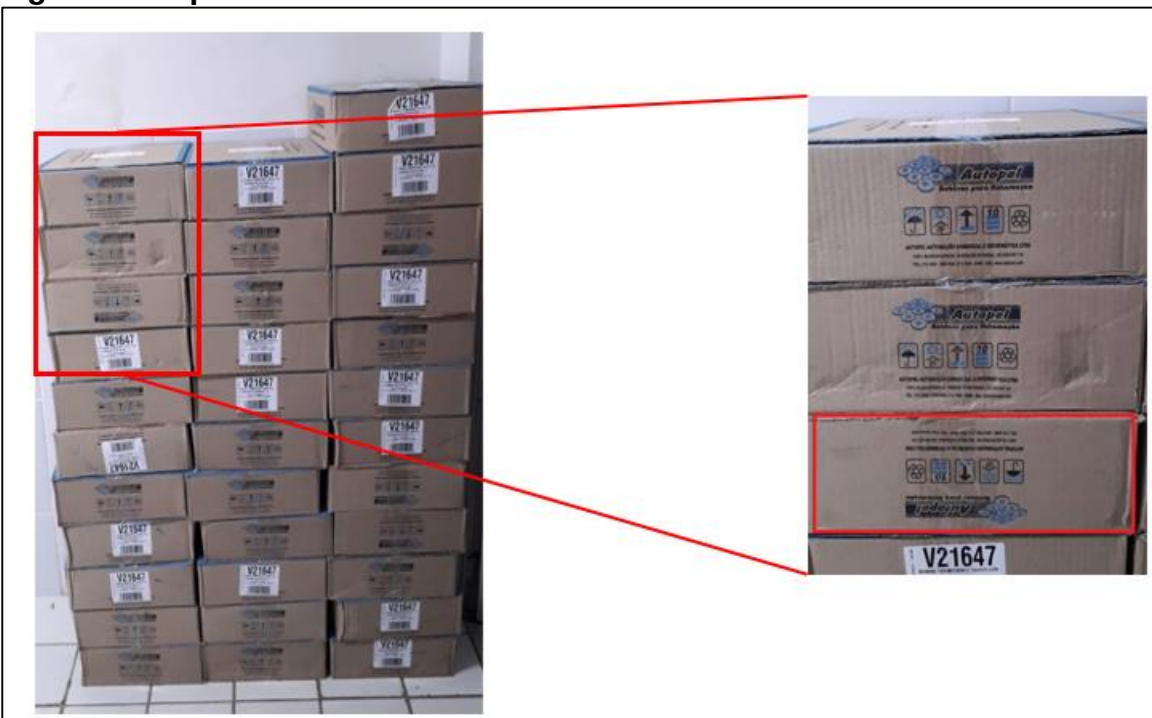
Figura 3: empilhamento não recomendado das bobinas
