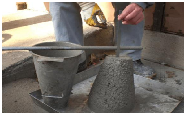
Figura 8 – Resultado possível do slump test
