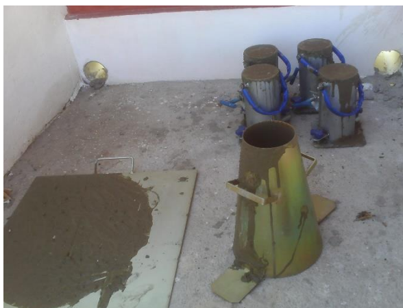
Figura 5 – Corpos de prova, placa base e tronco de cone
