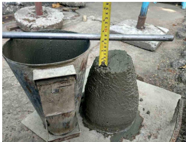
Figura 10 – Resultado possível do slump test
