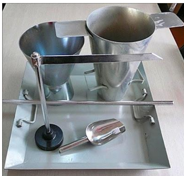
Figura 1 – Ferramentas para o slump test
