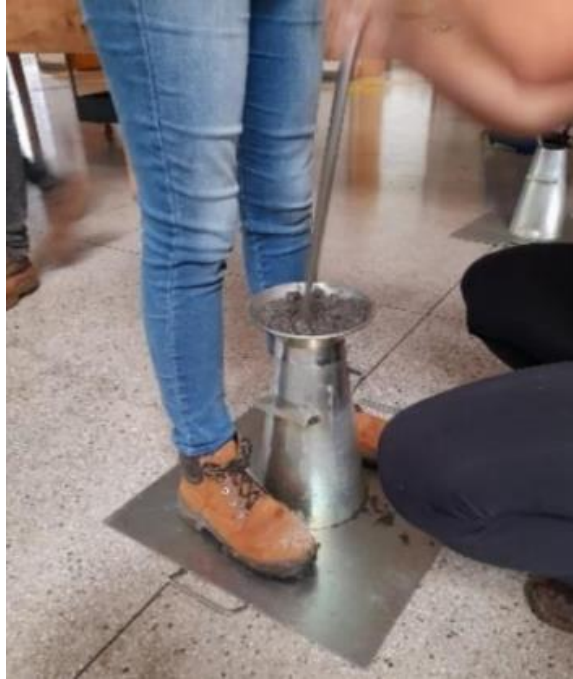
Figura 7 – Adensamento da terceira camada
