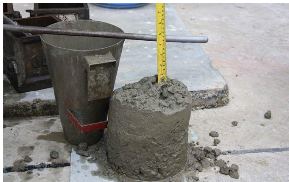
Figura 11 – Resultado possível do slump test
