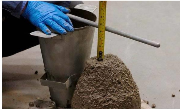
Figura 9 – Resultado possível do slump test
