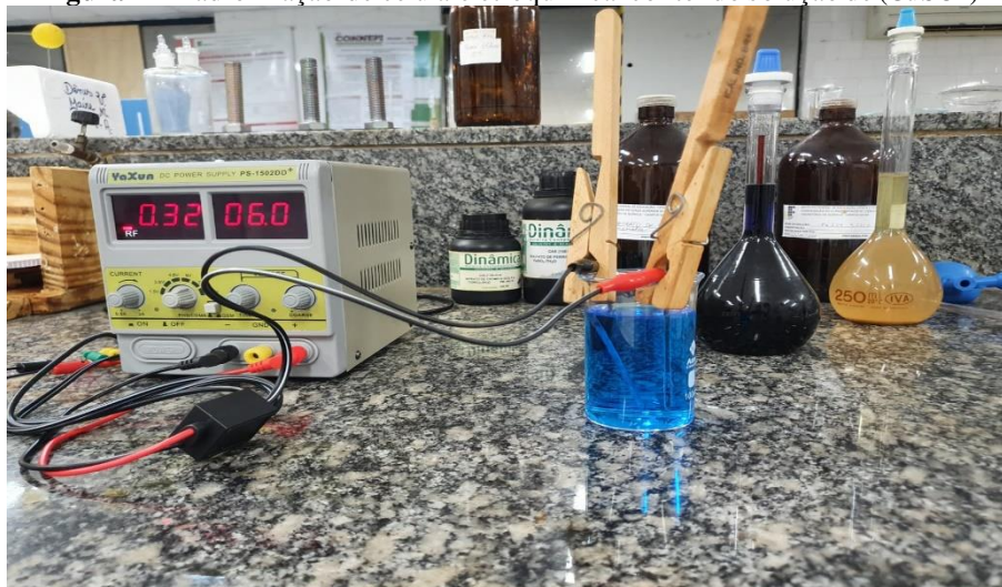
Figura 4 – Padronização de célula eletroquímica contendo solução de ( \text{CuSO}_4 )
