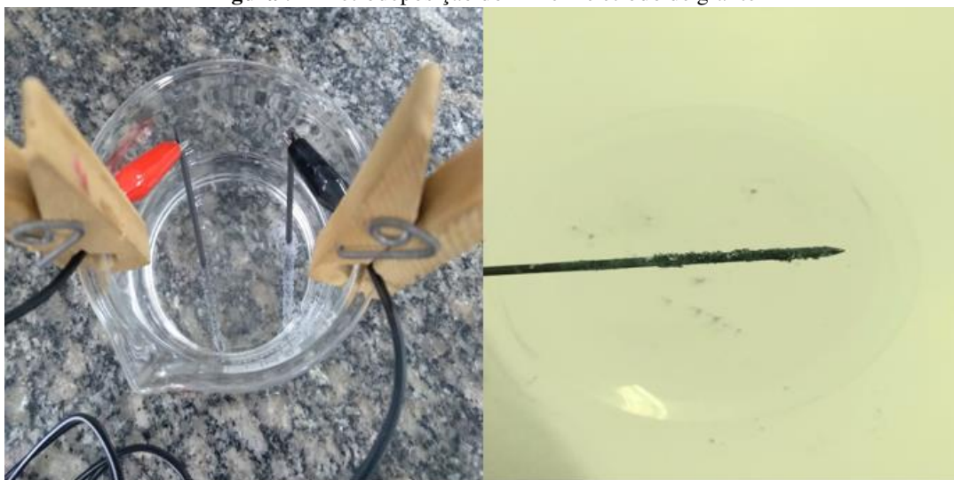
Figura 9 – Eletrodeposição do \text{Zn}^0 em eletrodo de grafite
