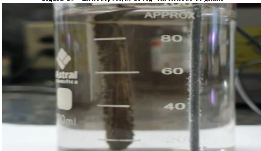
Figura 16 – Eletrodeposição de \text{Ag}^0 em eletrodo de grafite
