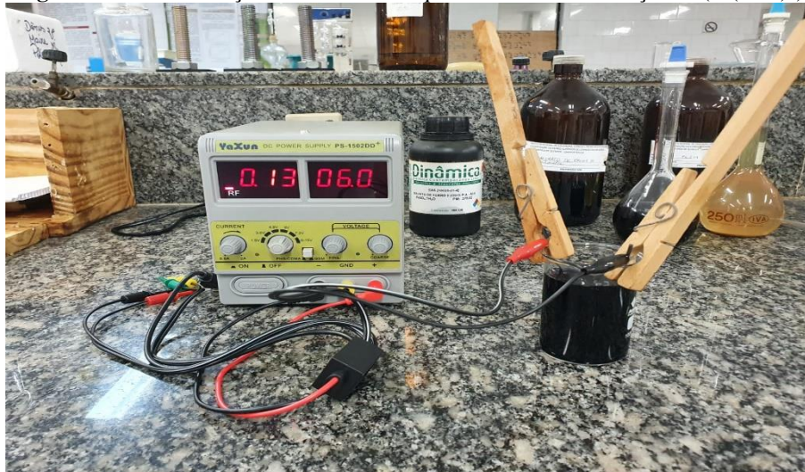
Figura 12 – Padronização de célula eletroquímica contendo solução de (\text{Cr}(\text{NO}_3)_3)
