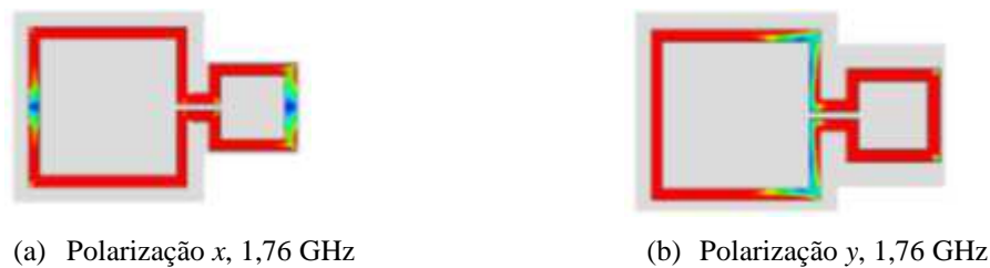
Fig. 3.11 – Distribuição da densidade de corrente elétrica considerando o anel da matrioska expandido.
