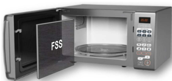
Fig. 2.14 – FSS utilizada como anteparo do forno de micro-ondas [10].
