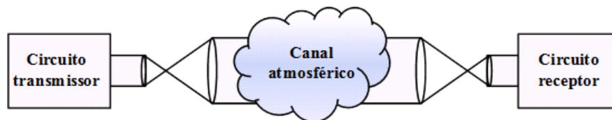
**Figura 2.1** – Representação simplificada de um enlace FSO.
