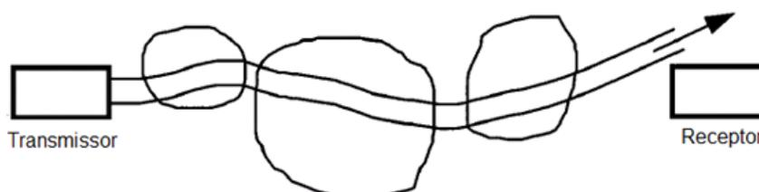
**Figura 2.14** – Deslocamento aleatório do feixe provocado por células turbulentas [26].
