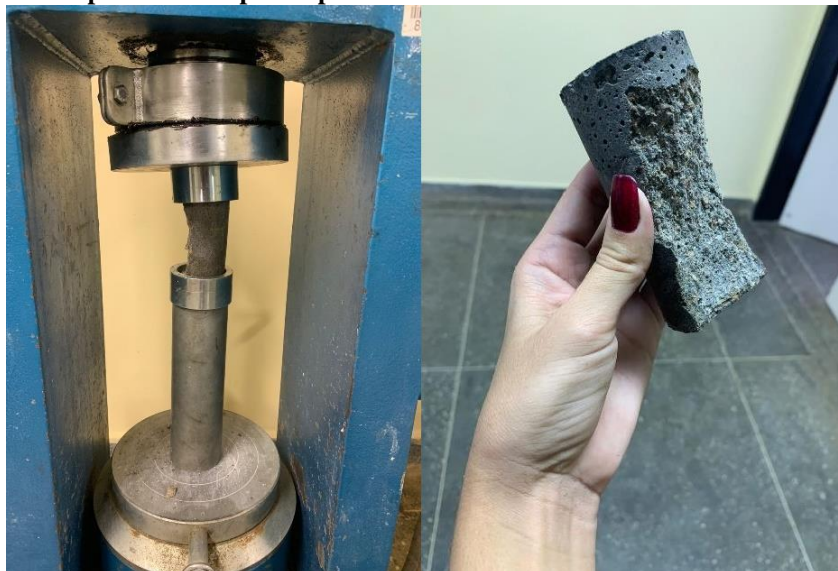
Figura 28 - Ruptura dos corpos de prova RCE submetido à cura com sulfato com 28 dias.
