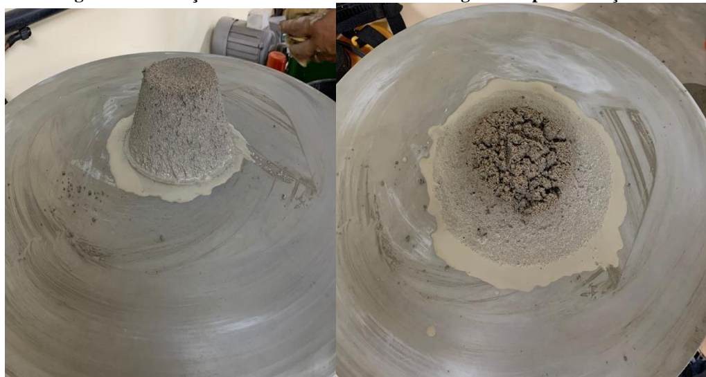
Figura 21 - Medição do índice de consistência da argamassa para o traço T2.
