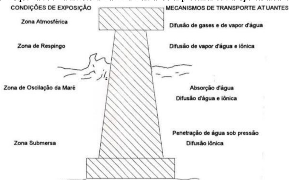
Figura 6 - Esquema de uma estrutura marinha mostrando os processos de transportes atuantes.
