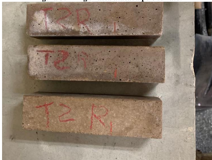
Figura 35 - Argamassa atacada pelo sulfato.
