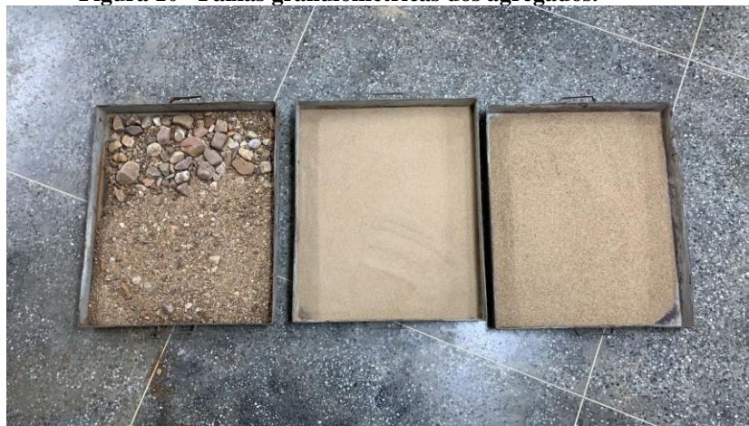
Figura 10 - Faixas granulométricas dos agregados.
