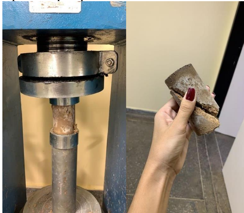
Figura 23 - Ruptura dos corpos de prova T2 submetido à cura com sulfato com 28 dias.
