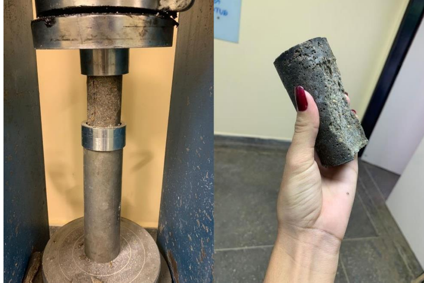
Figura 22 - Ruptura dos corpos de prova T1 submetido à cura normal com 7 dias.
