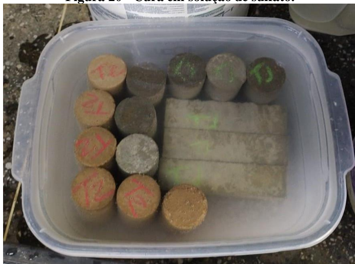
Figura 20 - Cura em solução de sulfato.
