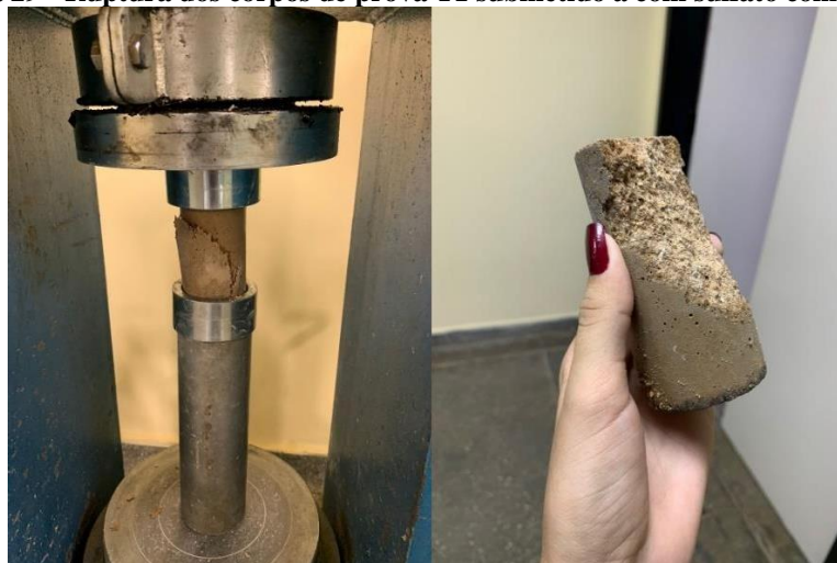
Figura 29 - Ruptura dos corpos de prova T1 submetido à cura com sulfato com 28 dias.
