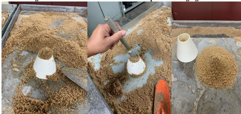
Figura 12 - Processo do ensaio da massa específica do agregado miúdo.
