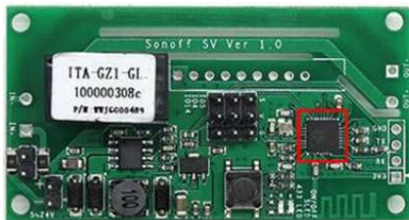
Figura 5 - PCB do Sonoff SV (detalhe do ESP8266 no destaque em vermelho)
