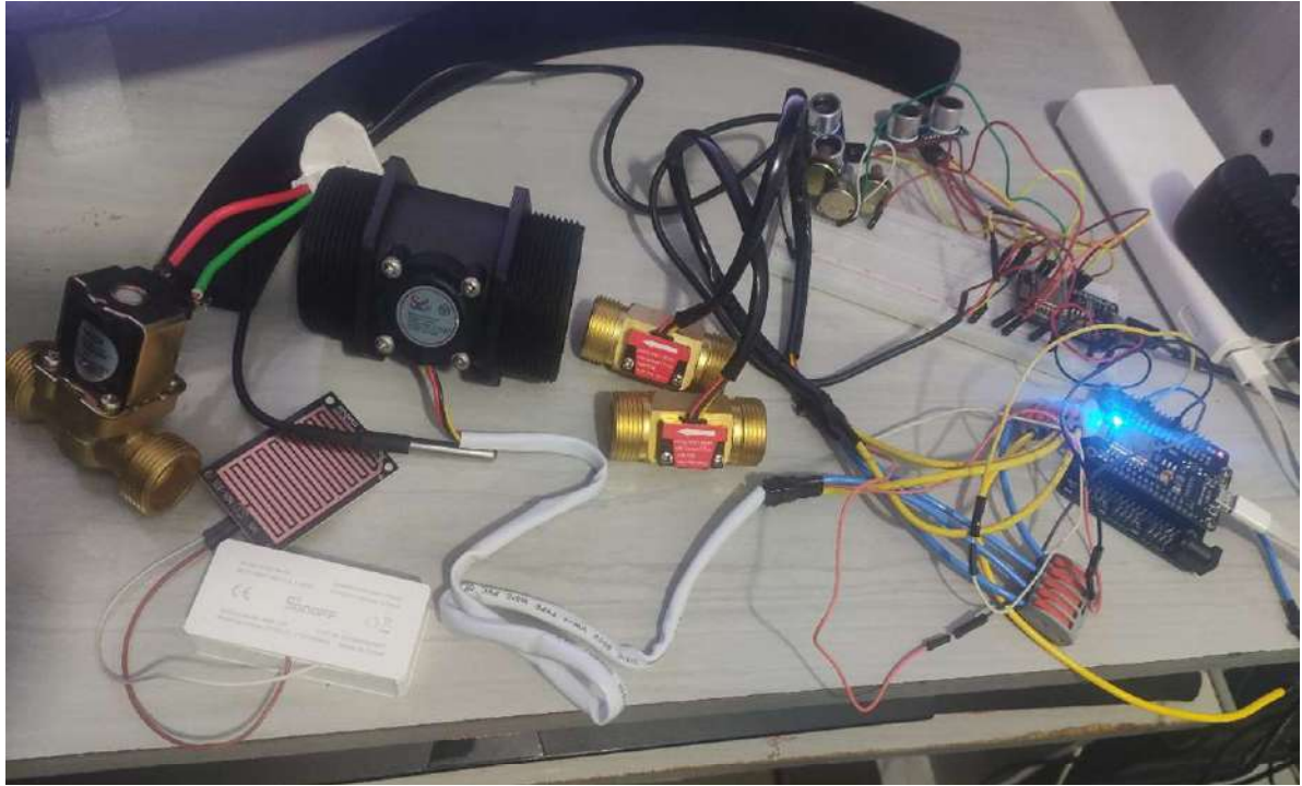
Figura 22 - Montagem dos dispositivos no ambiente de teste
