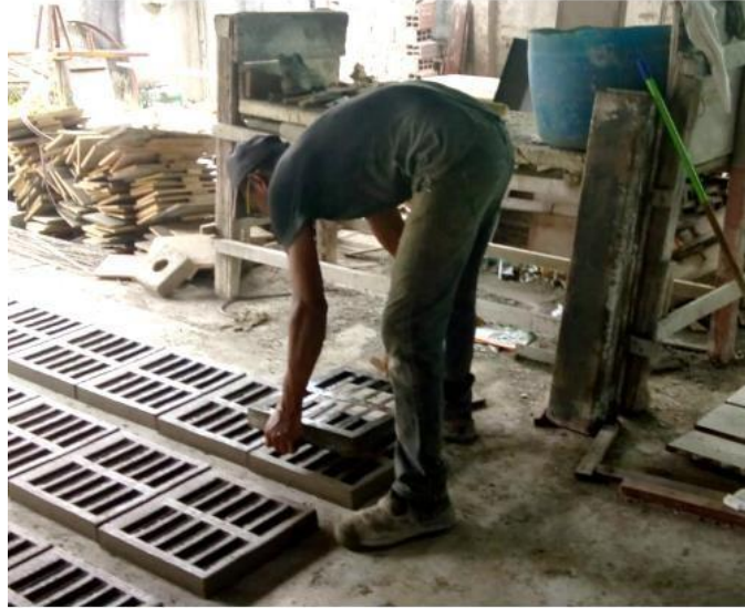
Figura 4 – Atividade de desmolde de material em produção e peças pré-moldadas.
