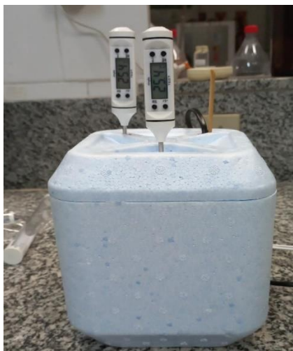
Figura 7. Aparato desenvolvido para demonstração de um aquecimento reversível aproximado
