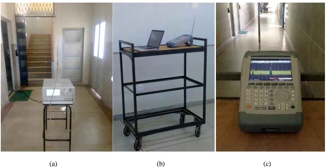
Figura 4.25: Setup de medição: TX (a) e base móvel com analisador de espectro com antena RX (b e c).
