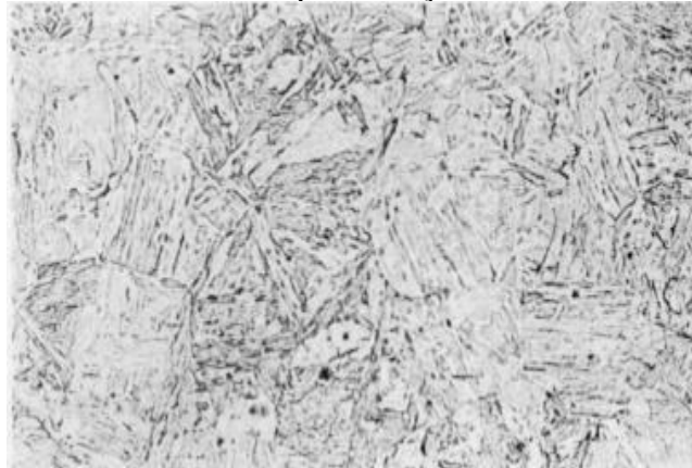
Figura 3 - Microestrutura típica do aço inoxidável martensítico.
