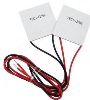
Figura 2 - Pastilhas de Peltier
