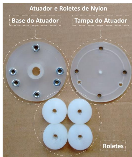
Figura 18: Descrição do atuador de nylon para a minibomba peristáltica de roletes.
