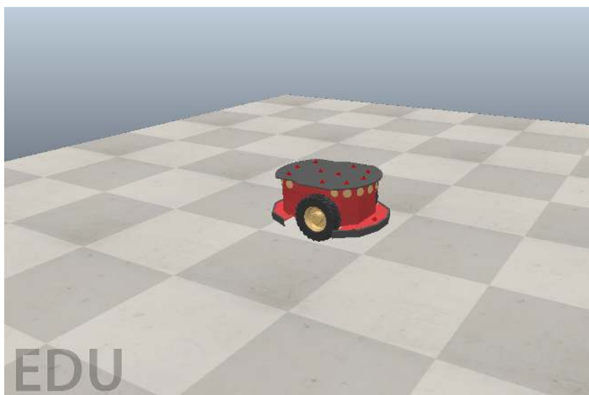
Figura 6 – Pioneer 3-DX no simulador CoppeliaSim. Fonte: Coppelia Robotics
