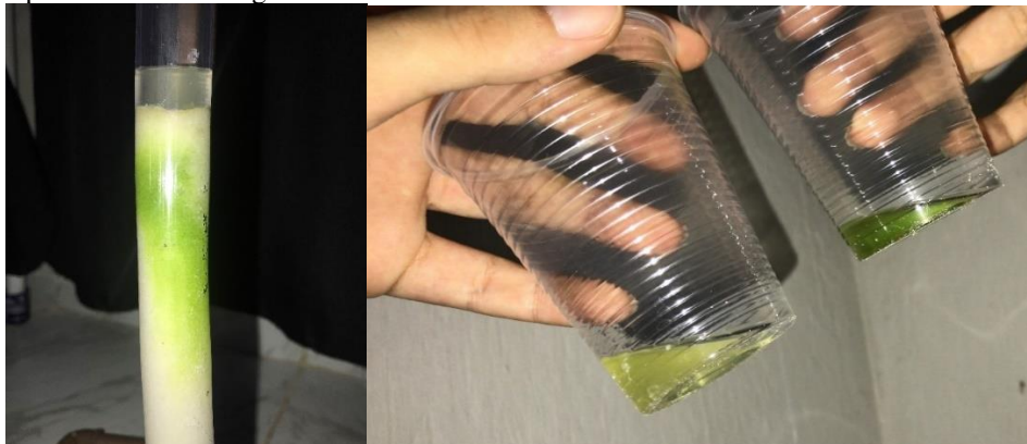
Figura 4 – (a) Coluna cromatográfica alternativa com areia, álcool isopropílico e o extrato da Jurema Preta. (b) Pigmentos separados na cromatografia.
