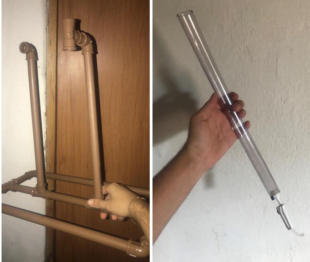
Figura 1 – Suporte (a esquerda) e coluna cromatográfica (a direita) confeccionados com material alternativo.
