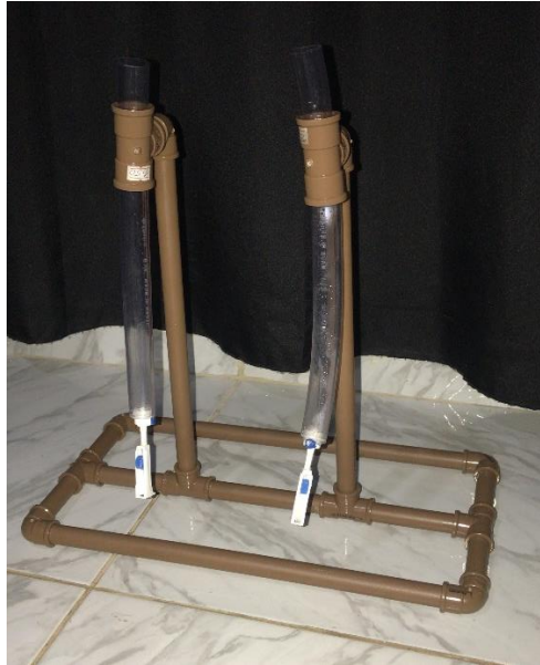
Figura 2 – Sistema alternativo montado para realização de experimentos com cromatografia em coluna.
