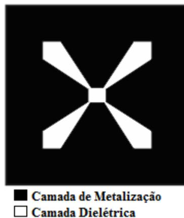
Figura 4.2: Geometria da estrutura: estrela de quatro braços tipo fenda.
