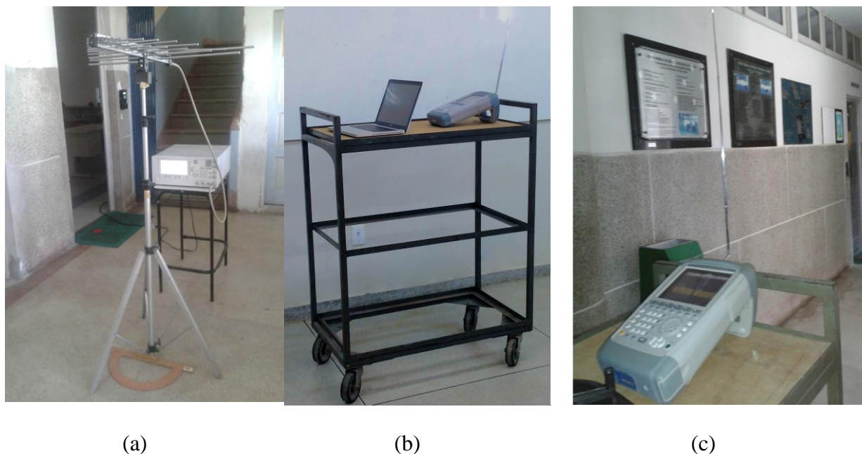
Figura 4.26 – Setup de medição: (a) TX com antena diretiva log periódica modelo 3148B na polarização horizontal, (b) base móvel com analisador de espectro e com antena RX e (c) detalhes do analisador de espectro.
