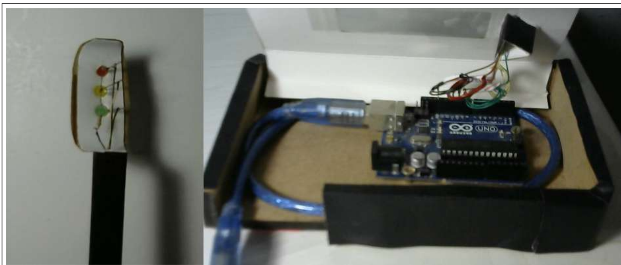
Figura 9 – Conexões do semáforo com o Arduino UNO e base de MDF
