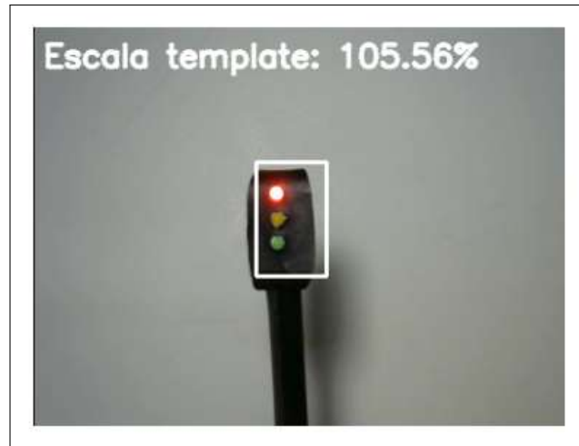
Figura 20 – Identificação e recorte do semáforo com template match
