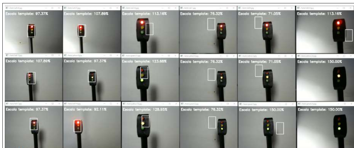
Figura 26 – Template match com variação de escala de 50% à 150%, com 20 passos, encontrando 21 semáforos em 30 imagens
