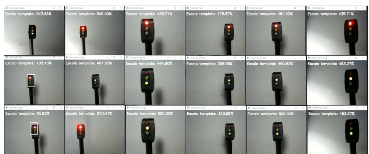
Figura 24 – Template match com variação de escala de 50% à 500%, com 50 passos, encontrando 30 semáforos em 30 imagens
