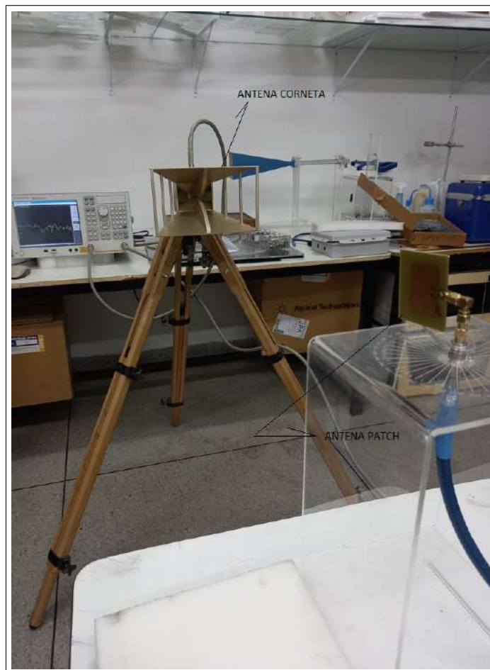
Figura 11 – Sistema montado para medição - AHV
