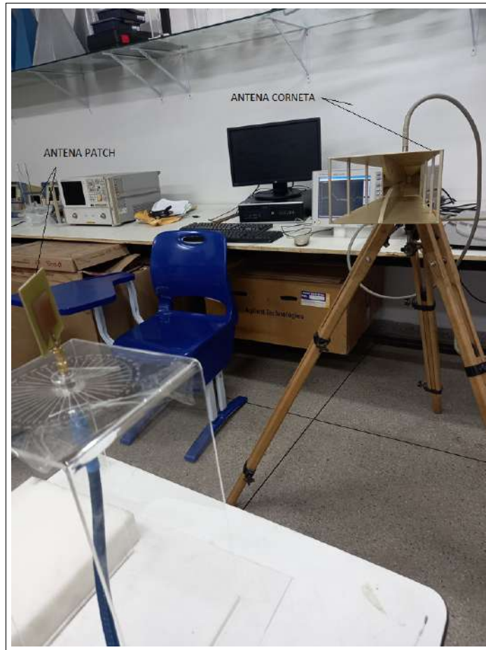
Figura 10 – Sistema montado para medição - AVV
