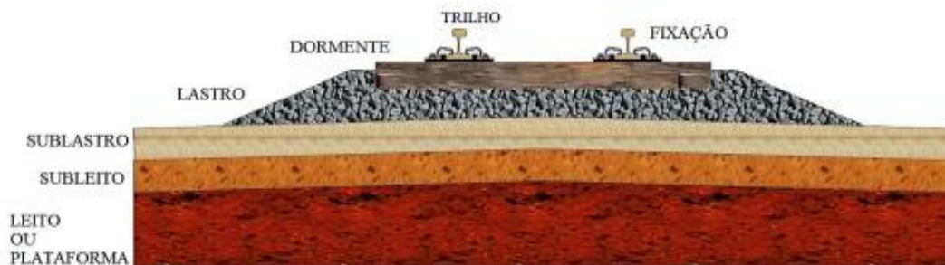
Figura 1 - Seção transversal do pavimento ferroviário
