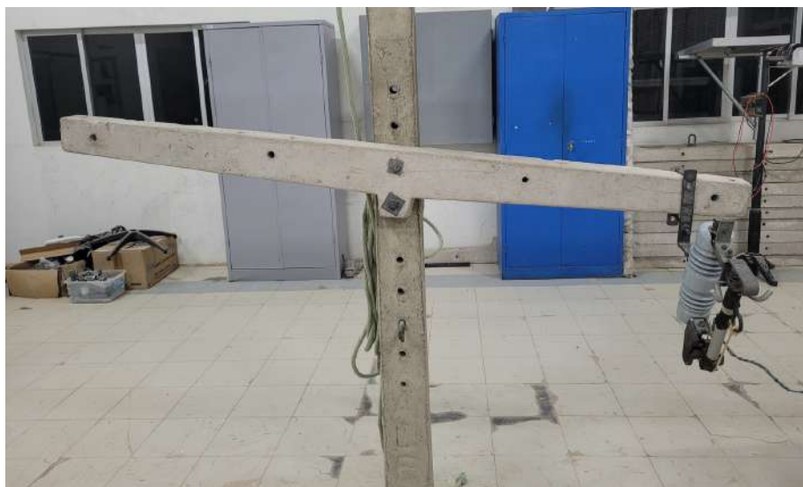
Figura 34 – Cruzeta com folga no eixo de fixação ao poste
