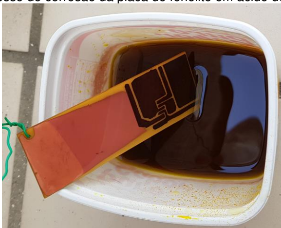
Figura 5.2 – Processo de corrosão da placa de fenolite em ácido de percloroeto de ferro.
