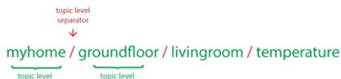
Figura 5 – Exemplo de estrutura de tópico MQTT. Fonte: (HIVEMQ, 2015).
