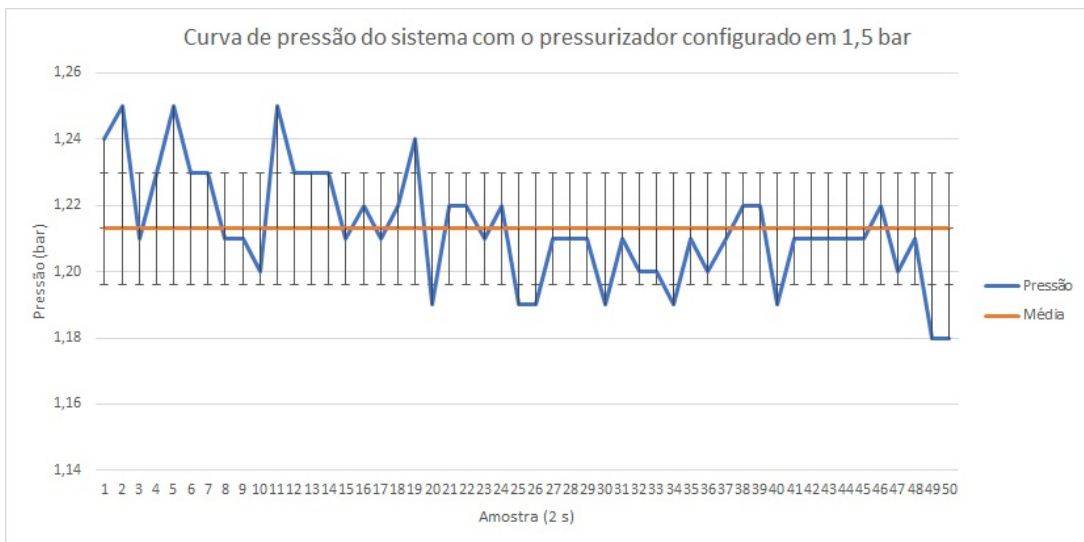
Figura 46 – Comportamento da pressão estática na bancada adaptada com pressurizador configurado em 1,5 bar. Fonte: Autoria Própria.
