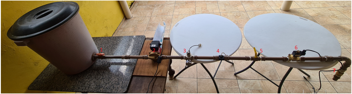
Figura 43 – Bancada adaptada ao método estático 1C da ABNT NBR ISO 4185:2009. Fonte: Autoria Própria.
