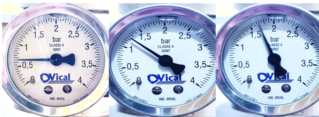
Figura 49 – Imagens de medição da pressão estática no manômetro analógico. Fonte: Autoria Própria.
