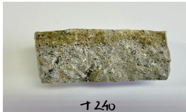
Figura 15 - Profundidade de penetração dos íons de cloreto nos traços T 240.
