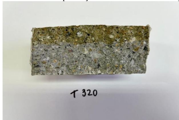
Figura 16 - Profundidade de penetração dos íons de cloreto nos traços T 320.
