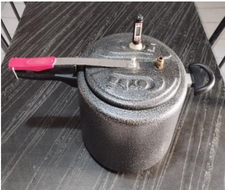
Figura 4 - Panela de pressão c/ termômetro
