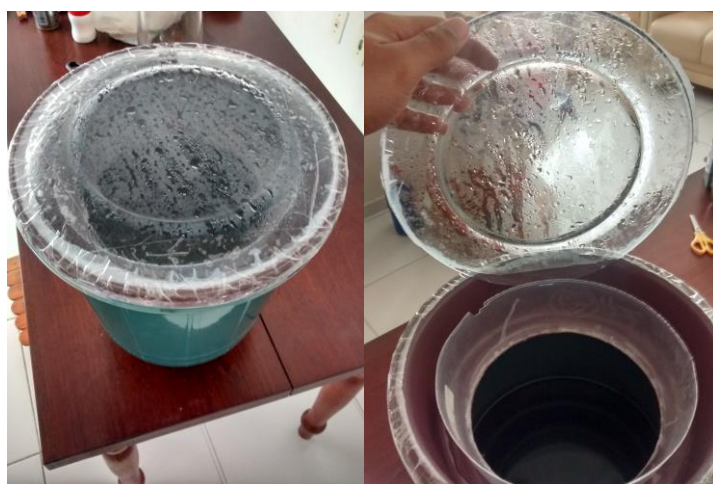
Figura 6: mudança do prato de vedação para otimização do equipamento e melhoria de visibilidade dos fenômenos de evaporação e condensação. Fonte própria.
