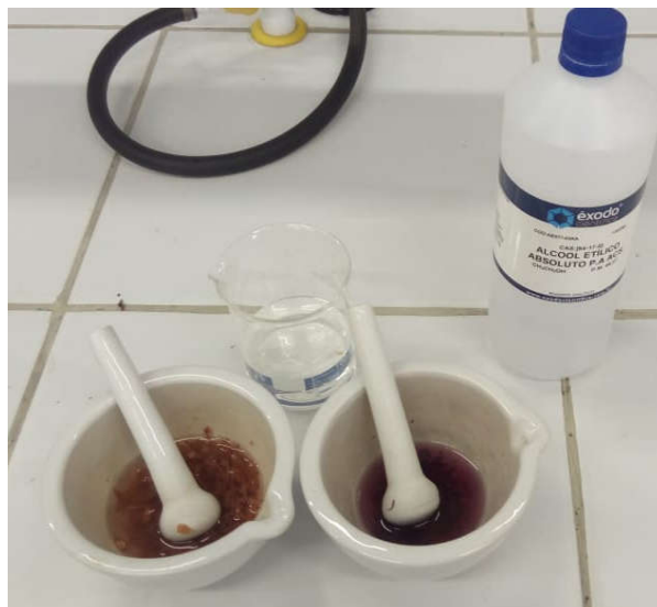
Figura16: Extração de antocianinas por maceração em álcool etílico P.A.
