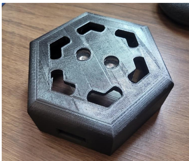
Figura 9 - Parte superior do invólucro com destaque para a furação do sensor de distância e do display OLED
