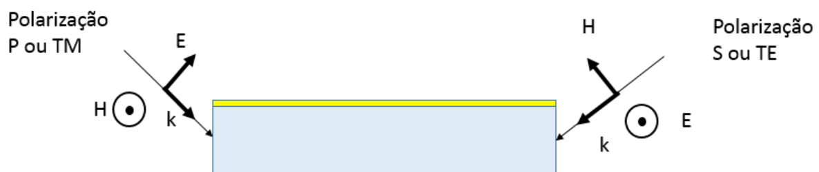
Figura 16. Polarização P ou S de uma Onda Incidente. Fonte: Elaborada pelo Autor.
