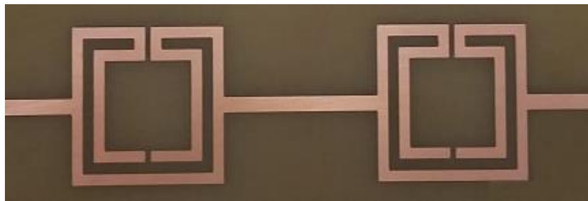
Figura 4-20 — Ressonador em cascata com dois anéis, Lext de 28 mm/20 mm e distância de 28 mm.
