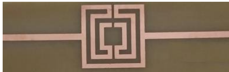
Figura 4-23 – Ressonador em cascata com três anéis Lext 28mm/20mm/12mm.
