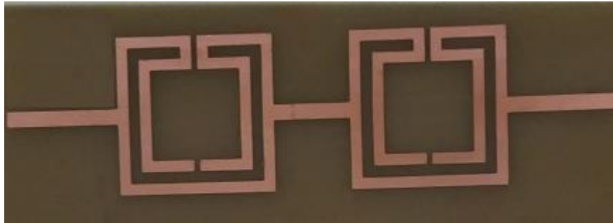
Figura 4-18 — Ressonador em cascata com dois anéis, L_{EXT} de 28 mm/20 mm e distância de 14 mm.
