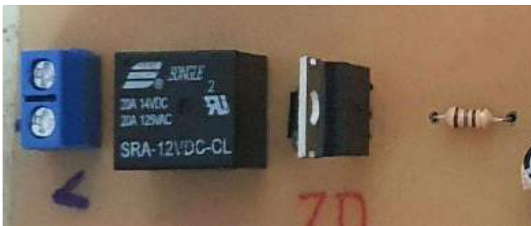
Figura 25 – Circuito de acionamento da solenoide na PCB.
