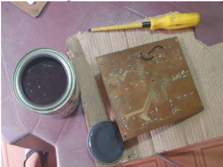
Figura 39 – Placa sendo envernizada.
