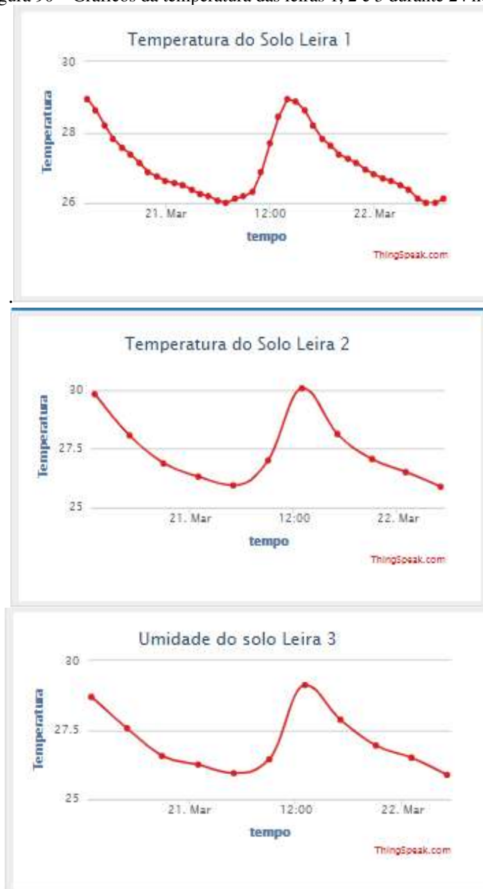
Figura 90 – Gráficos da temperatura das leiras 1, 2 e 3 durante 24 horas.
