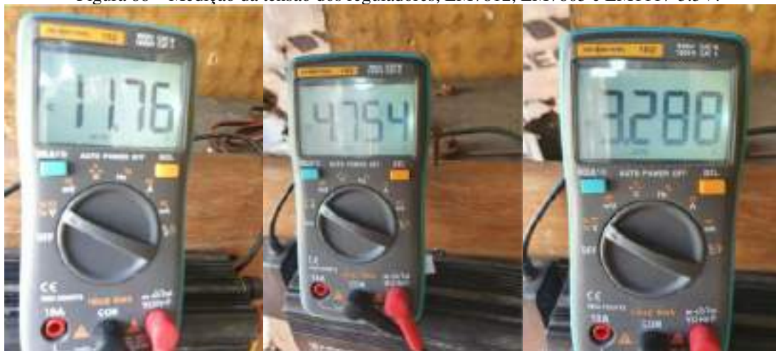
Figura 88 – Medição da tensão dos reguladores, LM7812, LM7805 e LM1117-3.3V.
