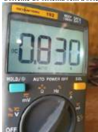
Figura 86 – Corrente do sistema sem a solenoide. Figura 87 – Corrente do sistema com a solenoide.
