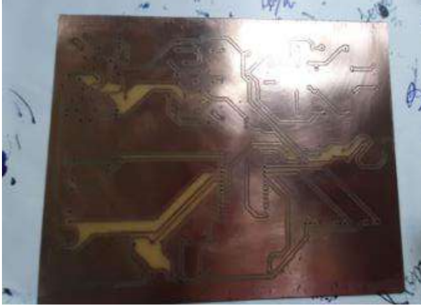
Figura 37 – Placa de fenolite corroída.
