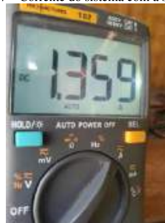
Figura 86 – Corrente do sistema sem a solenoide. Figura 87 – Corrente do sistema com a solenoide.
