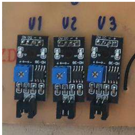
Figura 26 –Esquemático dos pinos dos sensores de umidade. Figura 27 –Sensores de umidade na PCB.
