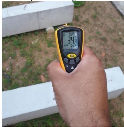
Figura 6 – Medida da temperatura da viga com termômetro infravermelho.
