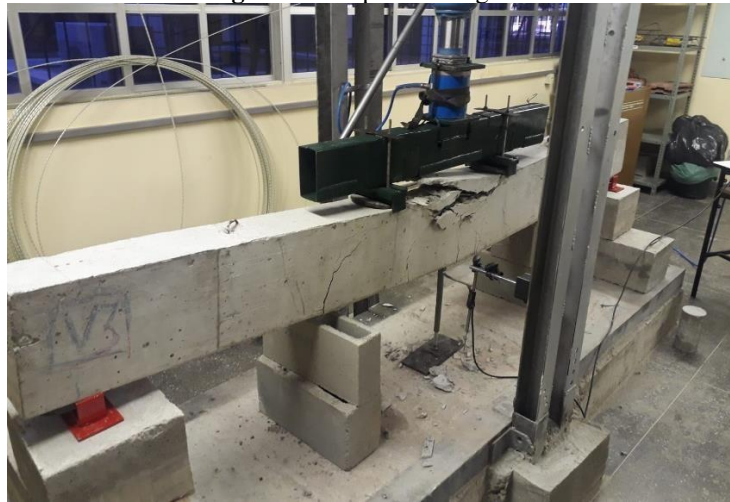
Figura 9 – Ruptura da viga V3.
