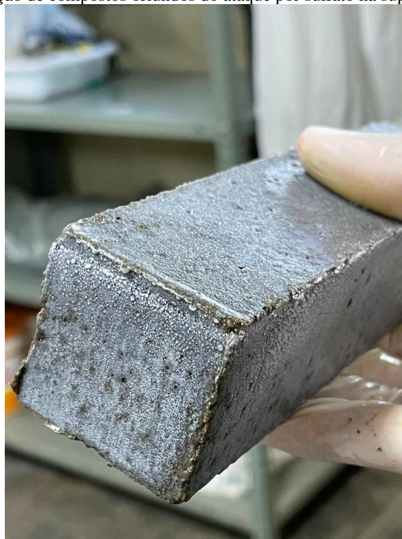
Figura 24 – Amostra da formação de compostos oriundos do ataque por sulfato na superfície do corpo de prova.
