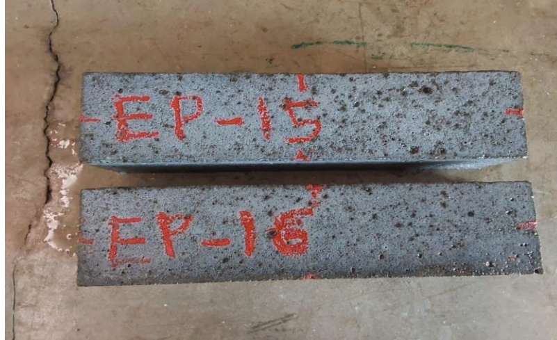
Figura 23 - Amostra de corpos de provas submetidos a ataque por sulfato de magnésio.
