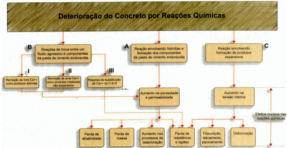
Figura 5 - Deterioração do concreto por Reações Químicas.
