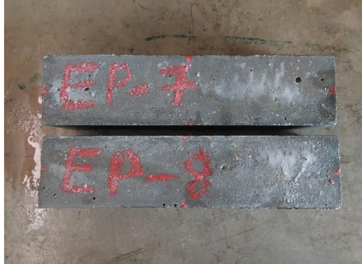
Figura 21 - Amostra de corpos de provas submetidos a cura em cal.
