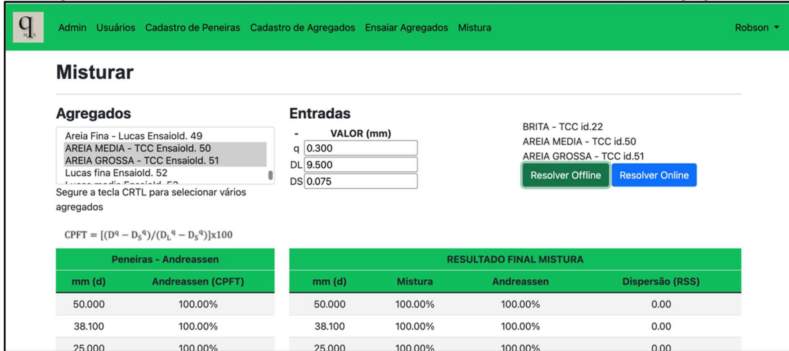
Figura 6 – Tela do software Q-Mix com os dados de entrada do cálculo da otimização dos agregados.
