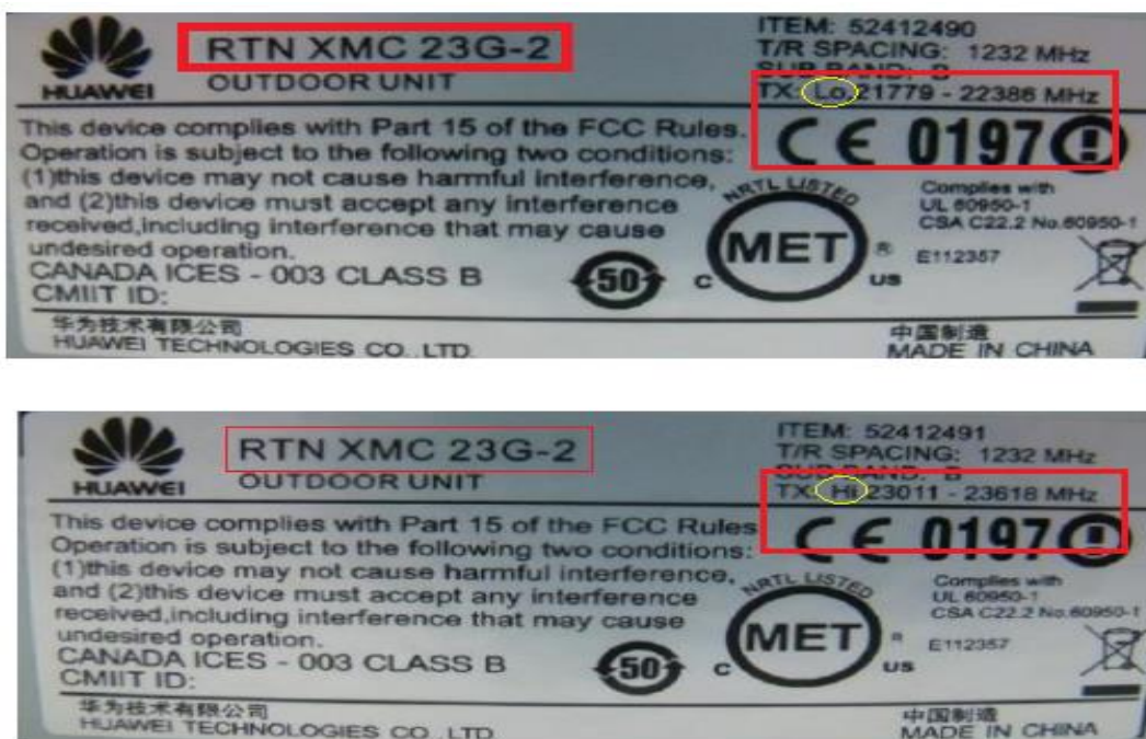
Figura 25- Exemplo de etiquetas de duas ODU's da HUAWEI
