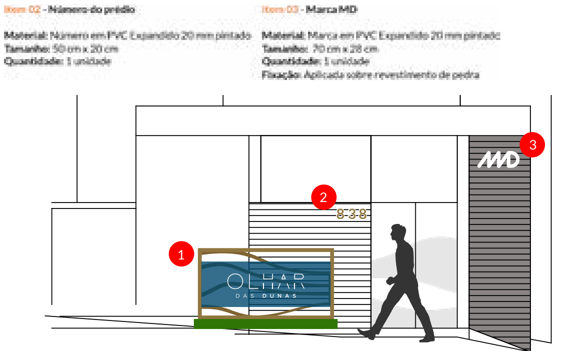
Figura 117 - Sinalização da entrada principal
