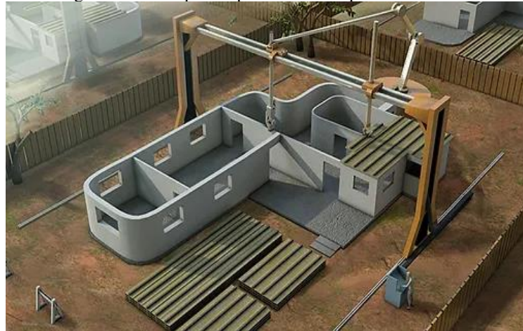
Figura 2 – Exemplo do processo de impressão com CC.
