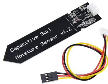
Figura 3 – Sensor de umidade do solo para arduino modelo SC05 da Casa da Robótica [12]
