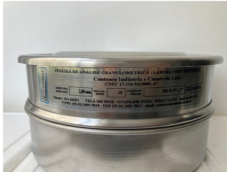
Figura 37 - Peneira granulométrica de 2 mm utilizada na preparação das amostras de substratos de solo.
