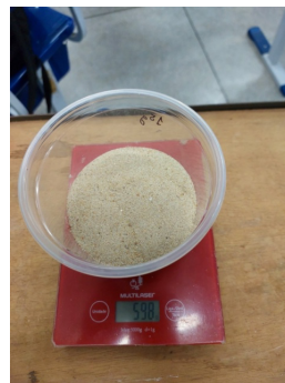
Figura 40 - Pesagem do substrato de areia de praia com balança de precisão
