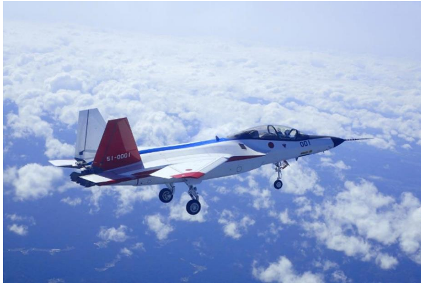
Figura 5 – Mitsubishi X-2 – Avião revestido com MARE.
