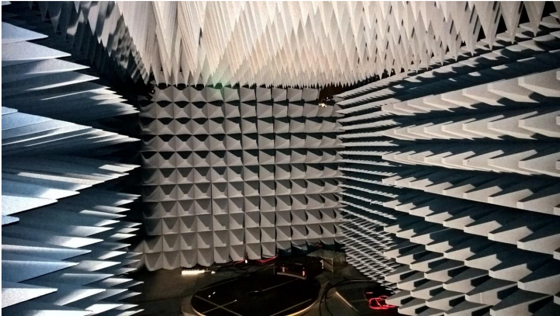
Figura 8 – Interior de uma câmara semi-aneecóica.
