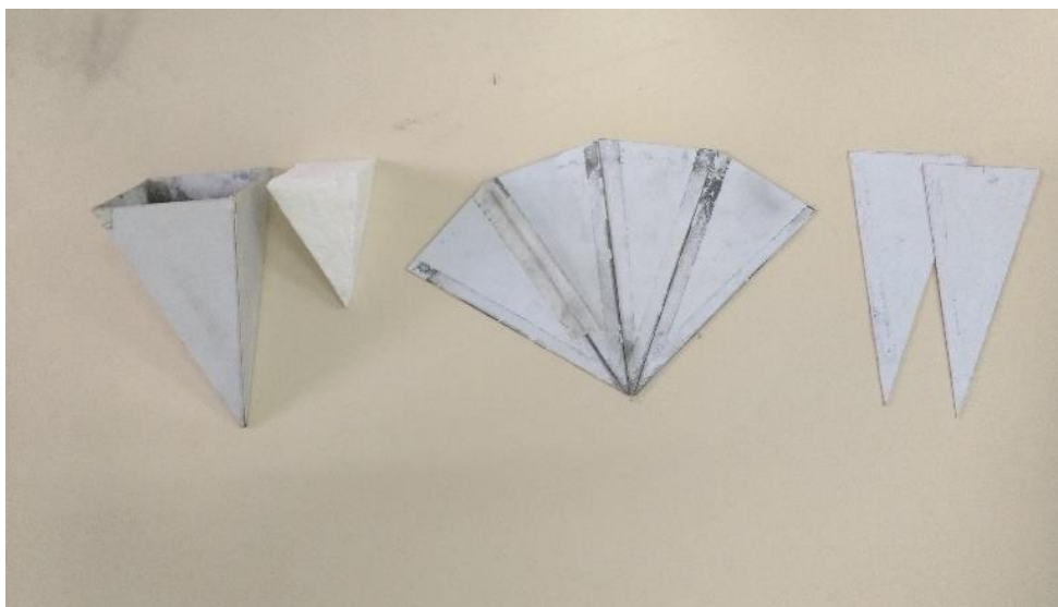
Figura 11 – Processo de montagem das pirâmides com a colagem das faces.
