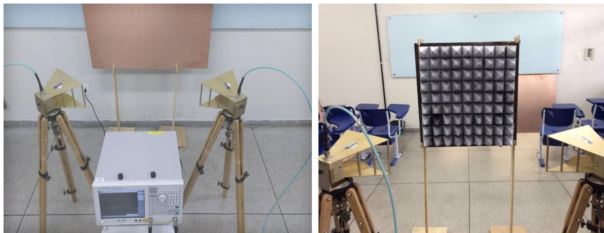
Figura 21– (a) Setup de caracterização da placa metálica de referência para medidas de refletividade. (b) Setup de caracterização do módulo absorvedor.
