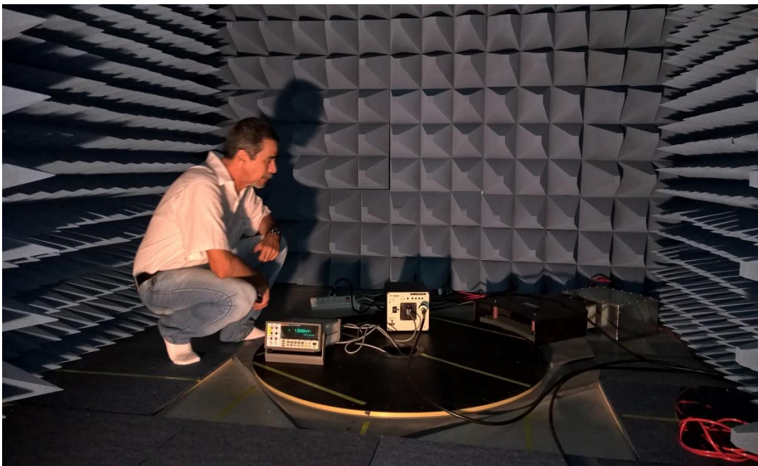
Figura 4 – Setup de medição de EMI no interior de uma câmara anecóica.
