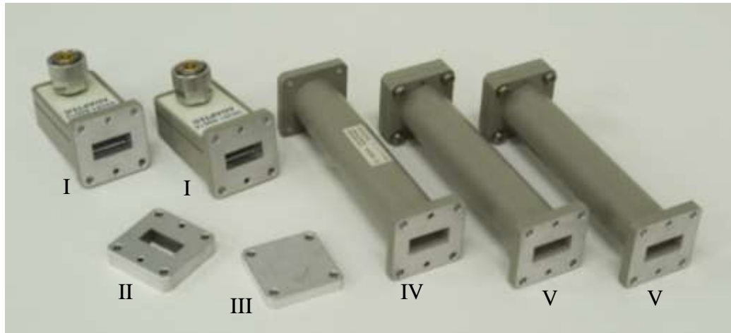
Figura 3.4 Conjunto de calibração WR90 para medições dos parâmetros S com guia de ondas. Fonte: Elaborado pelo autor
