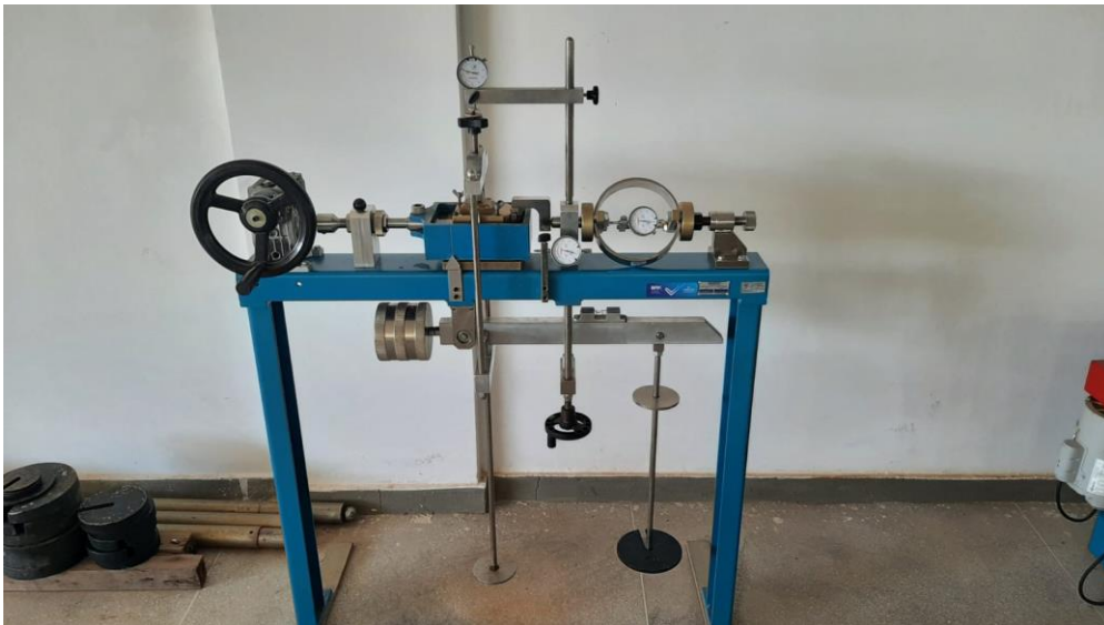
Figura 06 – Equipamento para realização do ensaio de cisalhamento direto
