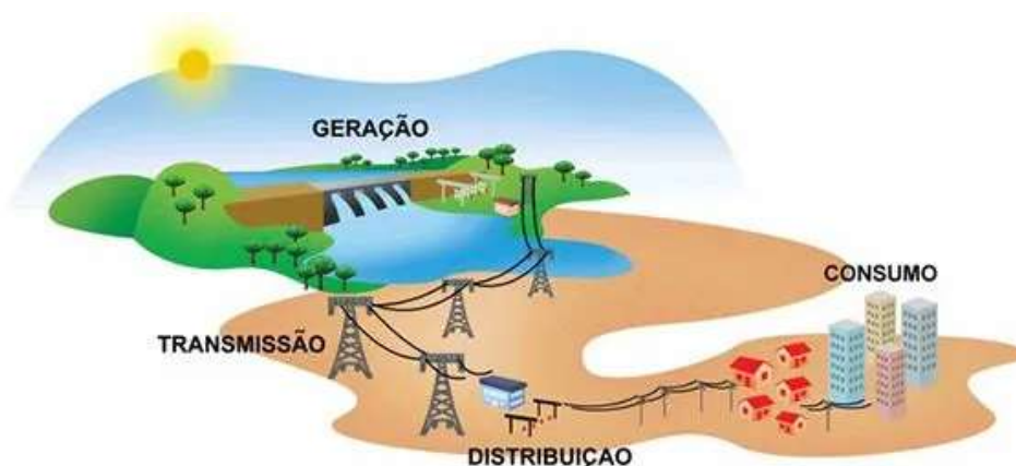
Figura 2 – O caminho da energia elétrica
