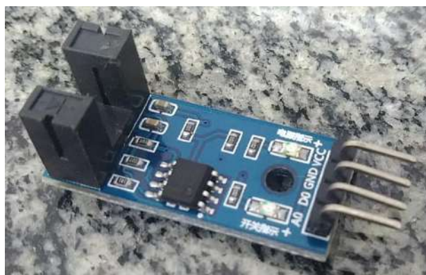
Figura 8: Sensor Chave Óptica Encoder 5 mm Utilizado na Etapa 3 do Desenvolvimento do Equipamento
