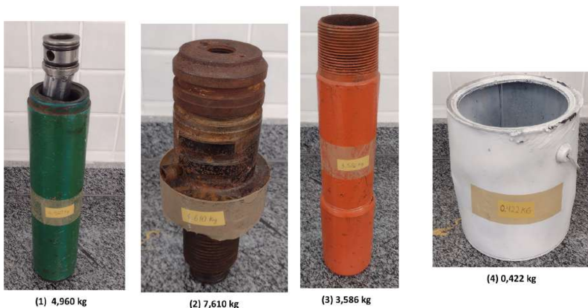
Figura 21: Pesos Utilizados para Calibração da Célula de Carga na Etapa 8 do Projeto
