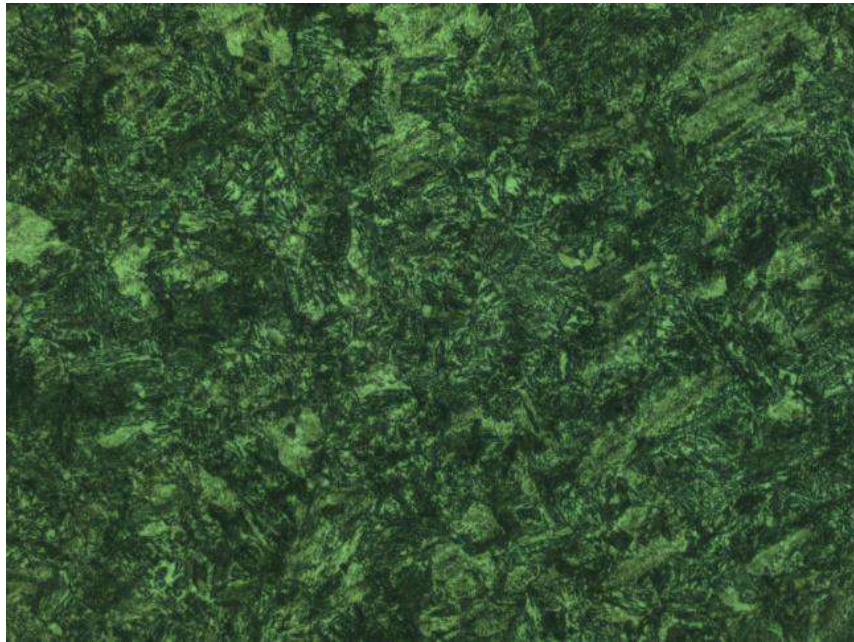
Figura 26. Amostra do aço SAE 4340 sem tratamento térmico (como recebida) (aumento de 200x).
