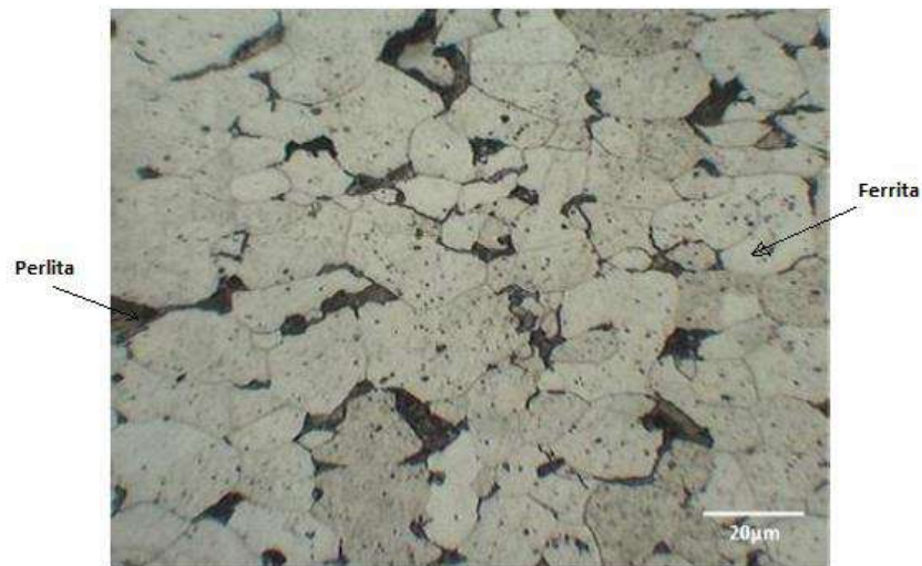
Figura 9. Microestrutura do aço AISE 1010 submetida a recozimento com aumento de 50x.
